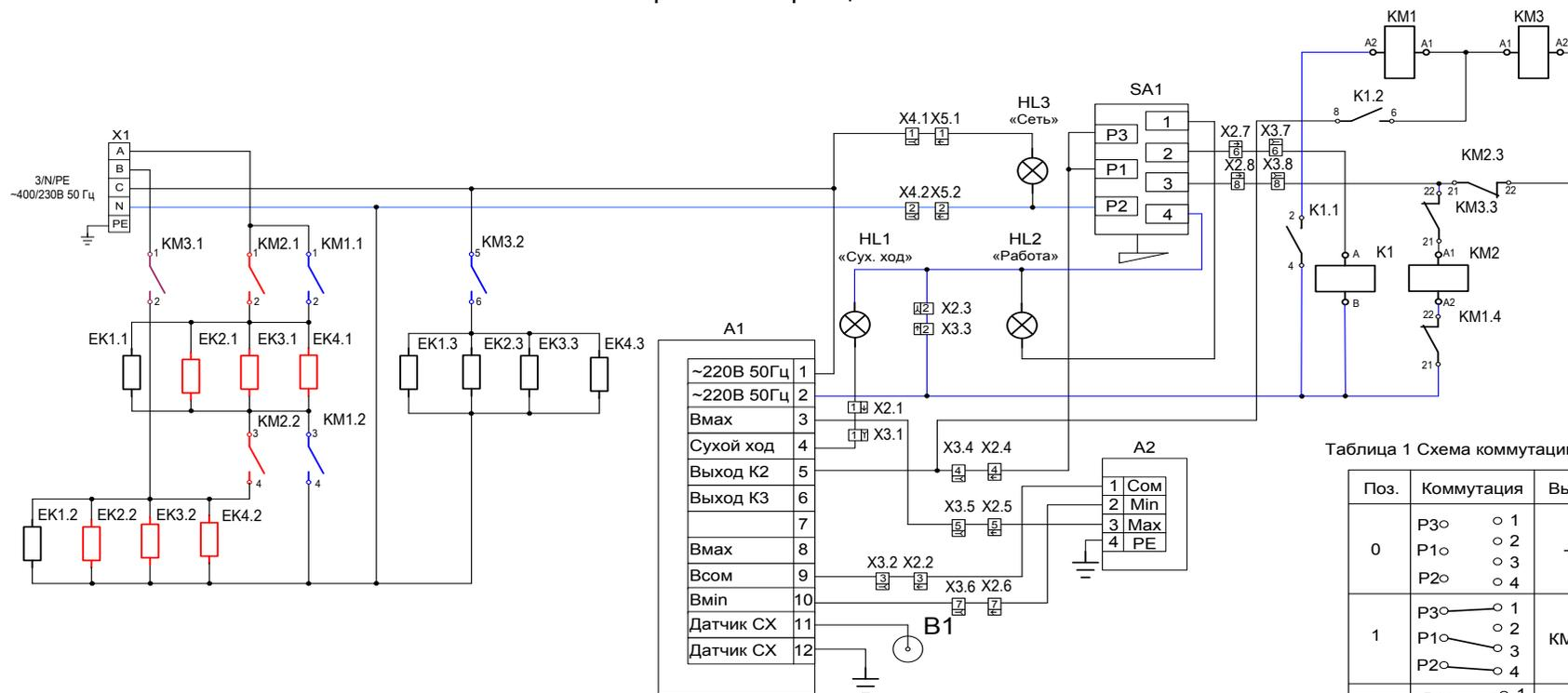
Таблица 1 Схема коммутации SA1.
