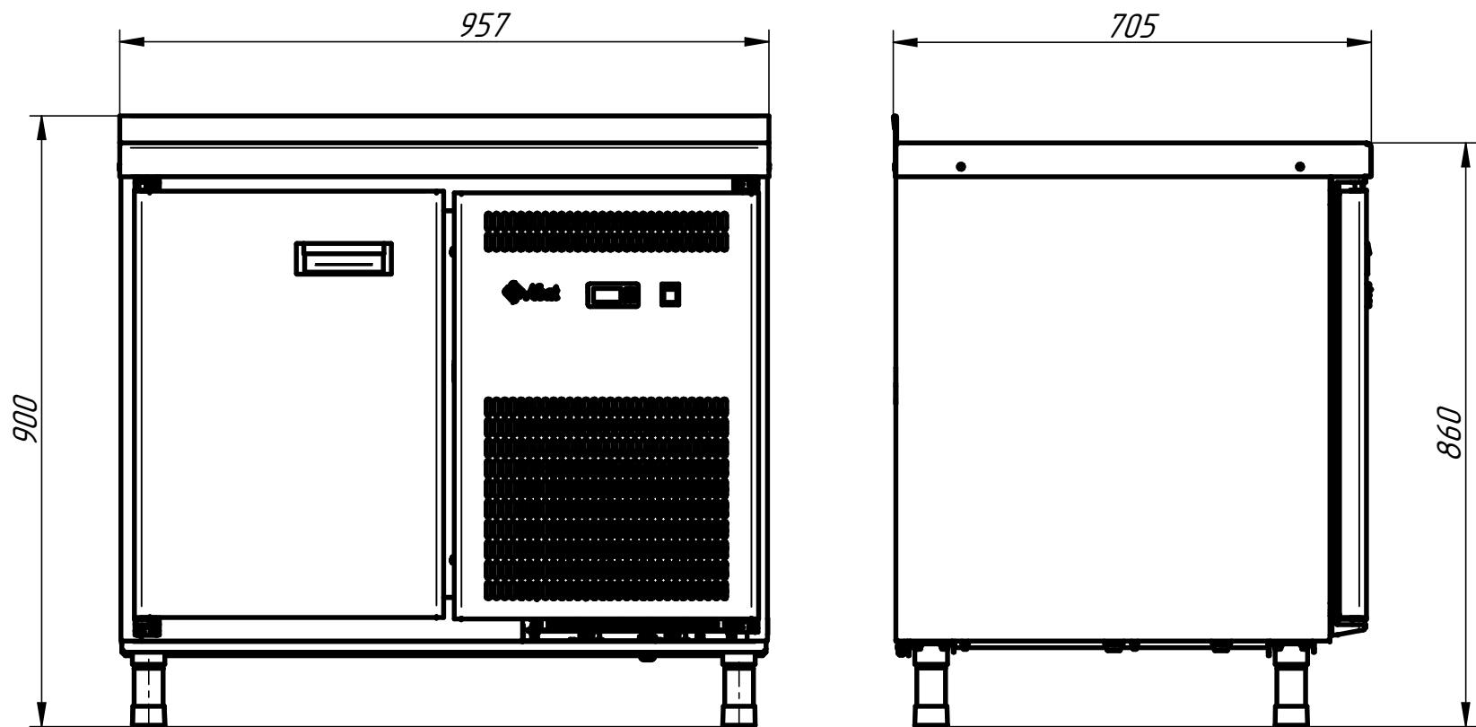
Стол (прилавок) холодильный низкотемпературный СХН-70 предназначен для кратковременного хранения на предприятиях общественного питания и торговли, предварительно охлажденных до температуры охлаждаемого объема пищевых продуктов. Стол (прилавок) используется как самостоятельно, так и в составе технологической линии. Эксплуатация холодильного стола (прилавка), допускается при температуре окружающего воздуха до плюс 42° С, относительной влажности от 40 до 70%.
